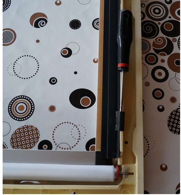
6) Afmonter de 6 clips, der holder plastskinnerne i begge sider.
